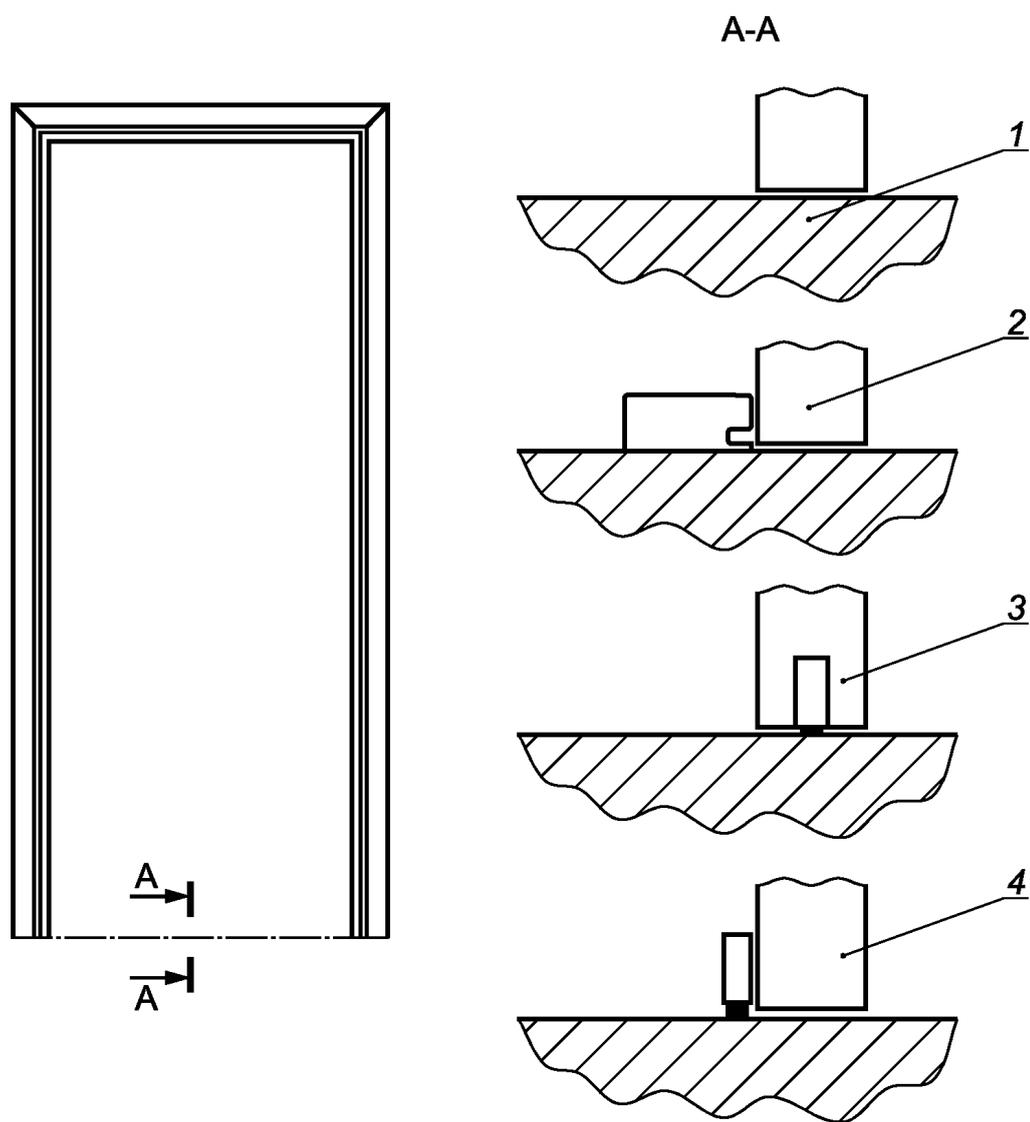
1 — без порога; 2 — с приставным порогом; 3 — с выдвижным порогом встроенного типа;
