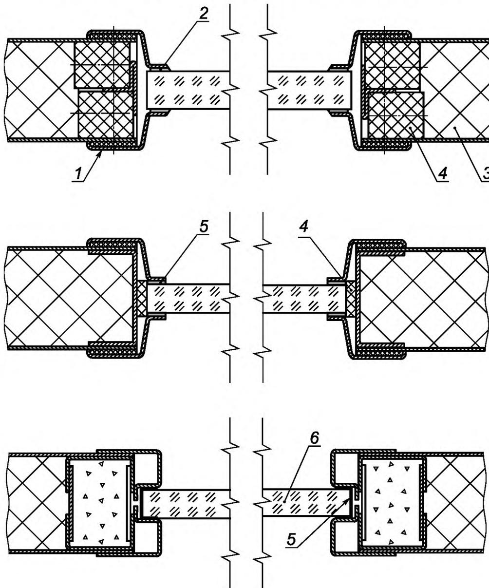
1 — стеклодержатель; 2 — уплотнитель; 3, 4 — негорючие теплоизоляционные материалы;
